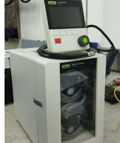
Bomba de Vacío
